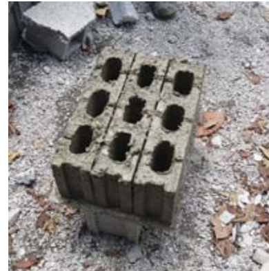
Figura 7. Proceso de curado; bloques a la intemperie.
