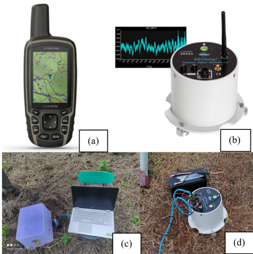
Fig. 2. Materiales utilizados en el ensayo geofísico HVSR. (a) GPS de mano, (b) sismógrafo triaxial, (c) computadora, (d) Batería conectada el sismógrafo.
