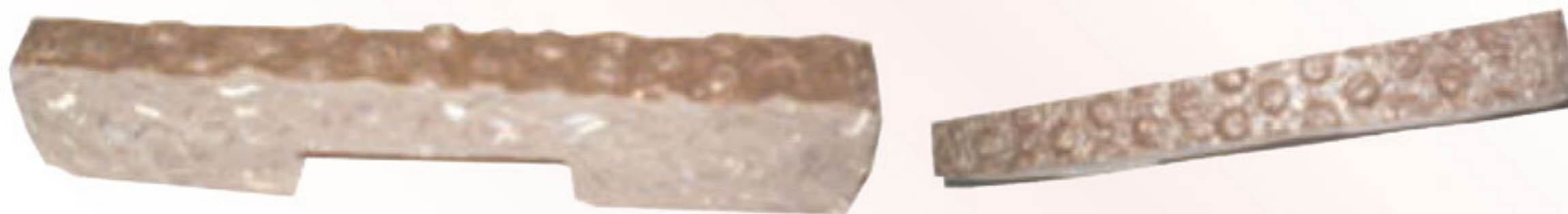
Producto plástico reciclado. Se observa el plástico termoestable como matriz fundamental y como material de adición en partículas menores, con colores blancos, verde, el plástico termoendurecibles.
