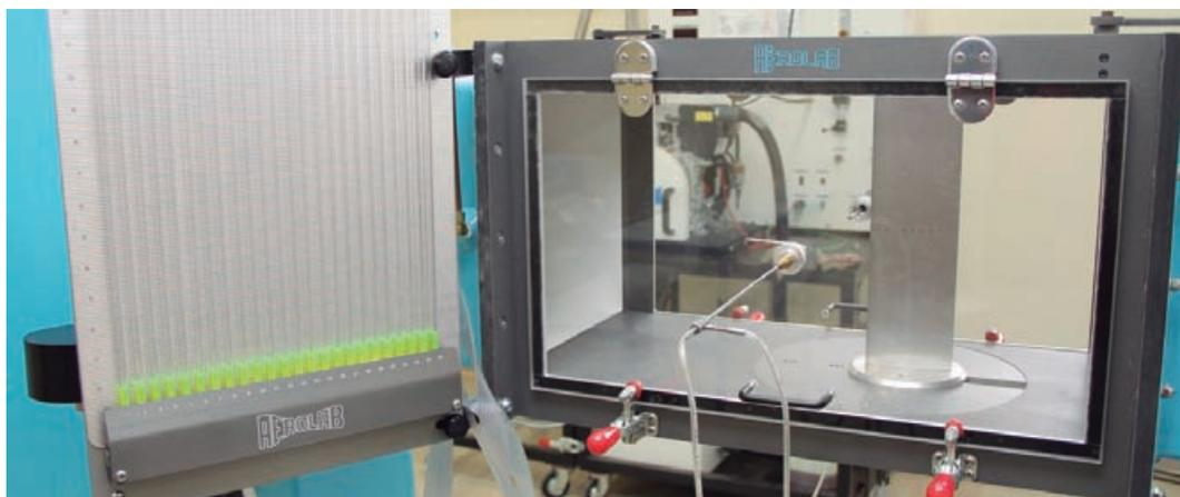
El túnel de viento o túnel aerodinámico es una herramienta utilizada en ingeniería para el estudio de los efectos del movimiento del aire alrededor de objetos sólidos, al simular las condiciones que experimentarán en una situación real.
