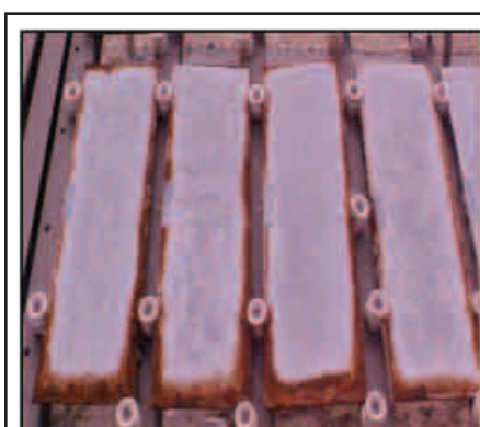
Figura 8. Estación Rompeolas, 6 meses de exposición, galvanizadas.
