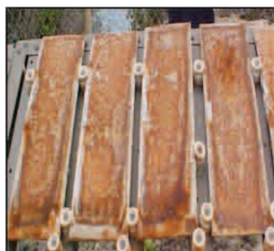
Figura 9. Estación Rompeolas, 1 año de exposición, galvanizadas.
