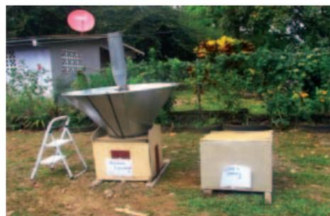
Figura 1. Estructuras Finales: Recinto Cerrado de Control versus Recinto con Sistema de Ventilación.
