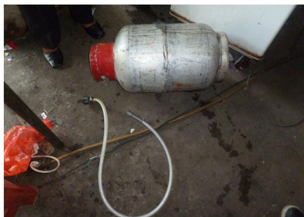
Figura 12. Manguera plástica para agua utilizada en la conexión de aparatos a gas.
