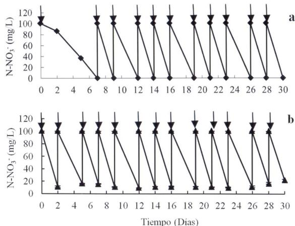
**Figura 1.** a) Las mediciones de nitrato en los ensayos de invierno reflejaron una completa desnitrificación b). En los ensayos de invierno se observó una remoción de nitrato por arriba 90 % (↓ dosificación de nitrato).
