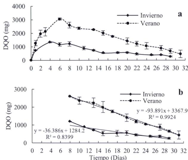
**Figura 4.** a) La masa de DQO del ensayo de verano fue mayor que el liberado en el ensayo de invierno; b) El comportamiento de la disminución de la DQO entre el día 8 y 29 fue similar en los ensayos de invierno y verano.
