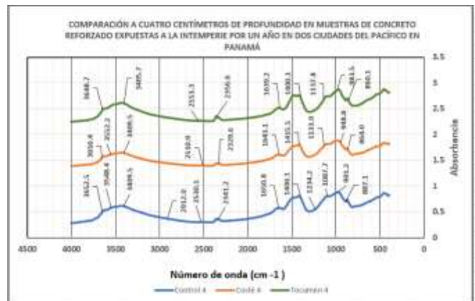
Figura 4. Espectro a cuatro cm de profundidad de las muestras de concreto expuestas por un año. Fuente: elaboración propia
