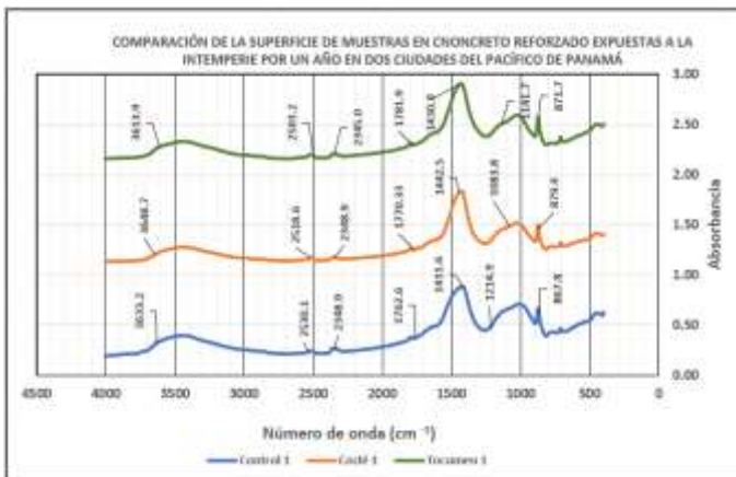
Figura 2. Espectro a dos cm de profundidad de las muestras de concreto expuestas por un año. Fuente: elaboración propia
