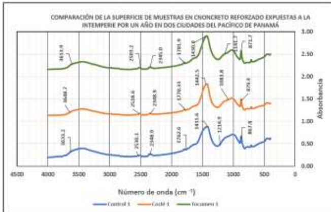
Figura 1. Espectro de la superficie de las muestras de concreto expuestas por un año. Fuente: elaboración propia
