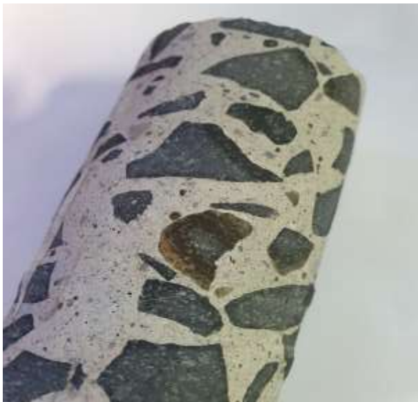
Figura 7. Núcleo de tres pulgadas de diámetro usado para análisis visual del perfil del concreto. Fuente: elaboración propia
