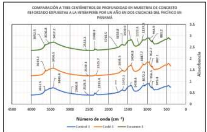
Figura 3. Espectro a tres cm de profundidad de las muestras de concreto expuestas por un año. Fuente: elaboración propia
