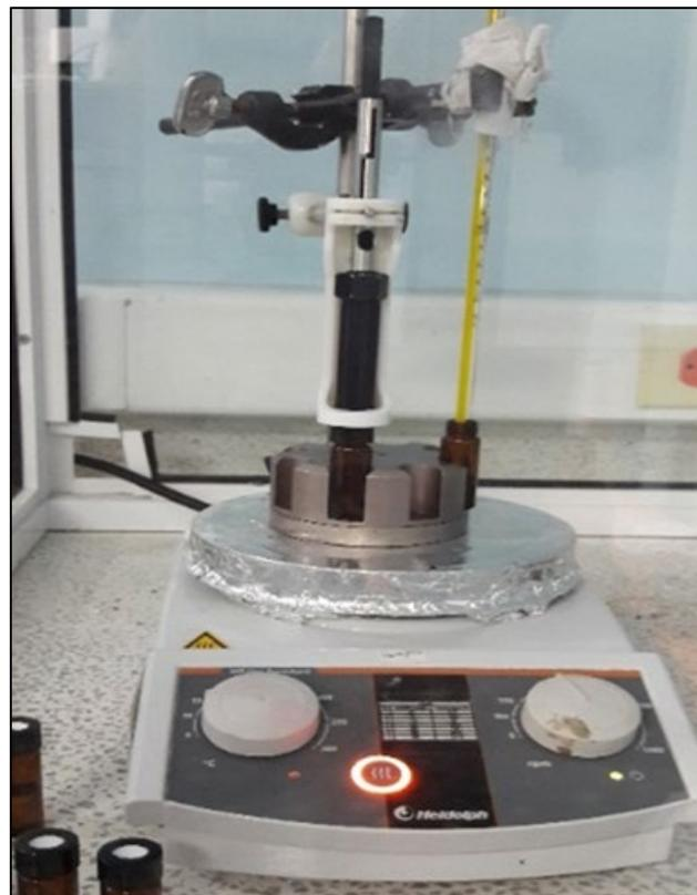
Figura 3. Montaje de la técnica microextracción en fase sólida (SPME).
