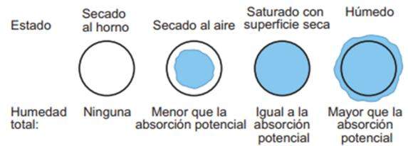
Figura 1. Condiciones de humedad de los agregados.
