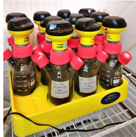
Figura 1. Montaje del ensayo en reactores tipo Batch usando el sistema OxiTop®.
