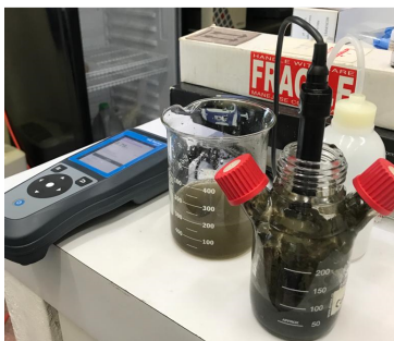
Figura 2. Medición de pH para los reactores al inicio.
