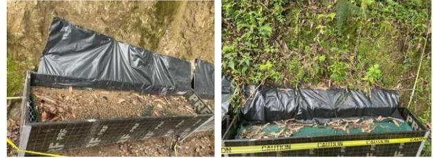
Figura 4. Recolección de muestras en la malla superior (sarán) para (izquierda) talud TD y (derecha) talud TC
