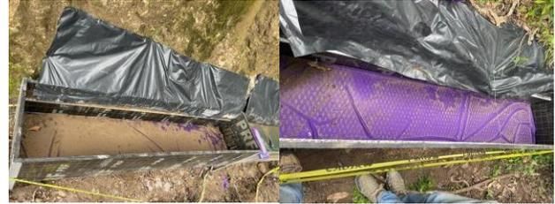
Figura 5. Recolección de muestras en la malla inferior (poliéster) para (izquierda) talud TD y (derecha) talud TC
