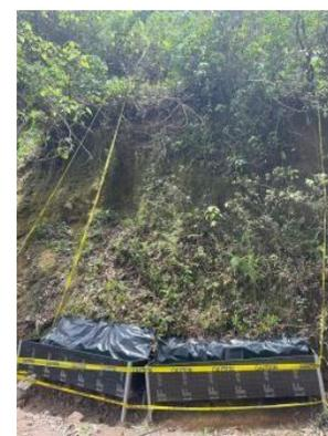
Figura 3. Sección experimental con cobertura vegetal (TC)
