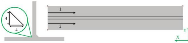
Figura 3. Líneas de soldadura continua.
