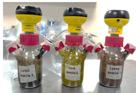
Figura 2. Montaje de reactores batch con lodos digeridos, estiércol vacuno y estiércol porcino como inóculos.
