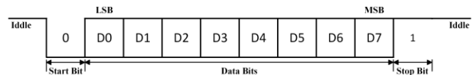
Figura 3. Formato 8N1 (sin bit de paridad) de trama UART en transmisión serial desde el LSB al MSB.
