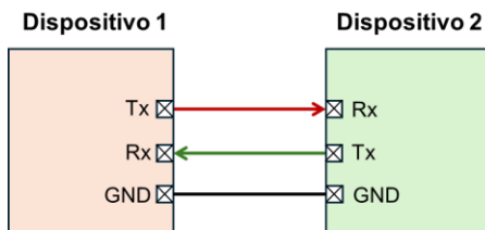
Figura 2. Esquema de conexión UART entre dos dispositivos
