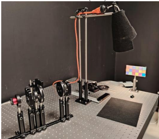
Figura 9. Arquitectura de un Solo Píxel Transmisiva (LCD) con su sistema de iluminación.
