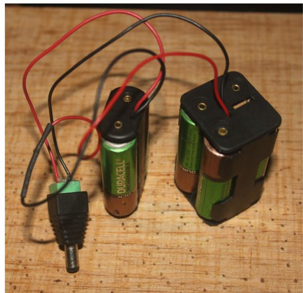
**Figura 2.** Fuente de alimentación de la placa Arduino UNO.
