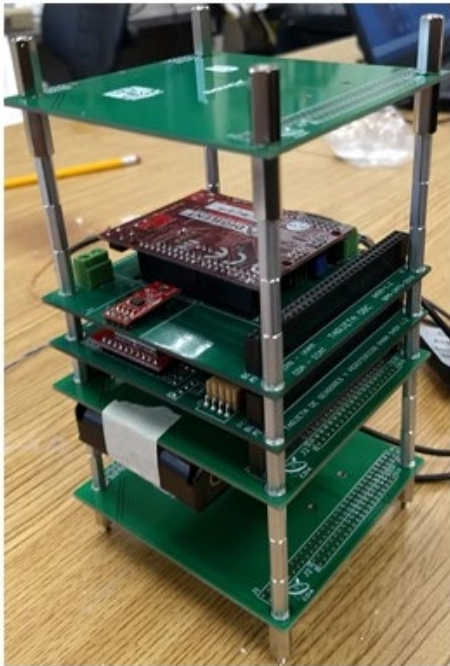
Figura 13. Sistema SADM y tarjeta de expansión para sensores y equipos periféricos.
