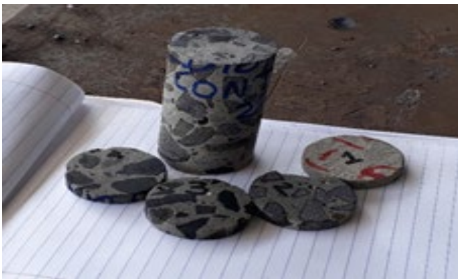
Figura 1. Probeta de 2 pulgadas cortada en capas de 1cm.
