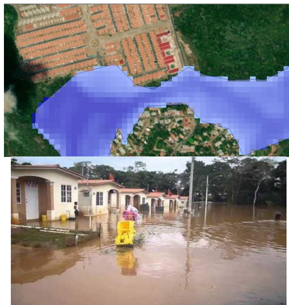
Figura 21. Punto 2. El Trapichito: Los Flamingos. Tanto la simulación como la fotografía muestran la salida del río de su cauce natural afectando el área de la Planta de Tratamiento de Aguas Residuales.
