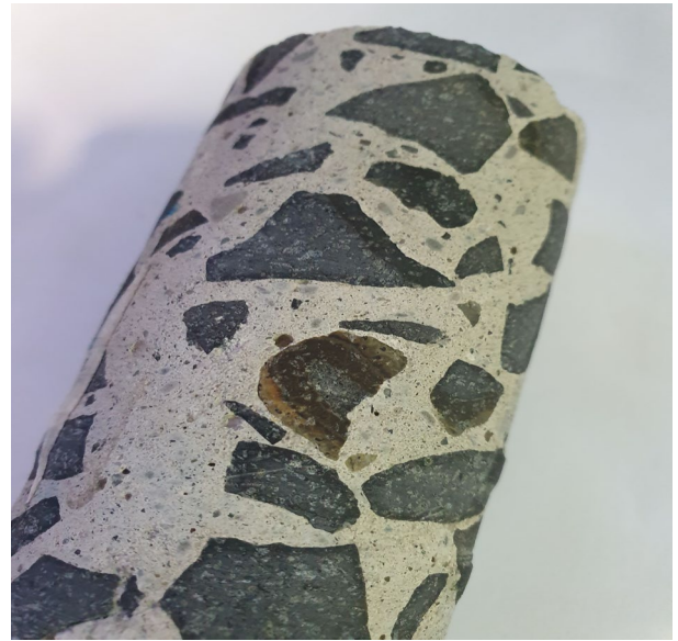
Figura 7. Núcleo de tres pulgadas de diámetro usado para análisis visual del perfil del concreto.
