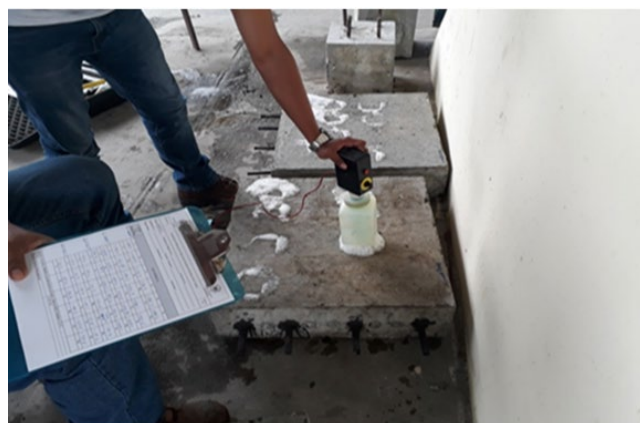
Figura 6. Ensayo de medición de potencial
