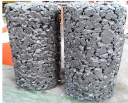
**Figura 4.** Cilindros de concreto poroso sin superficie de yeso y cemento.
