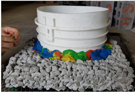
Figura 6. Anillo de filtración de 11.5'' de diámetro.
