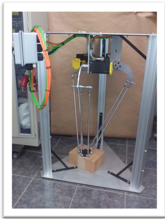
Figura 5. Robot Paralelo tipo Delta.
