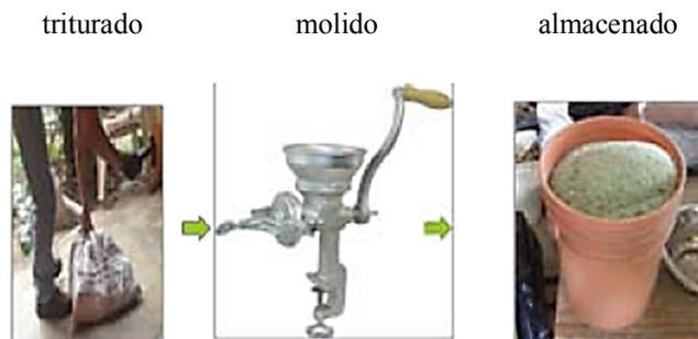
**Figura 7.** Procedimiento de trituración y molienda del vidrio de desecho. Almengor et al. (2017).
