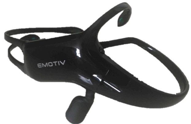
Figura 3. Interfaz de captura de señales encefalográficas Emotiv Insight.
