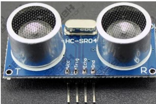
**Figura 8.** Sensor de Ultrasonidos HC-SR04. Fuente: <http://www.geekfactory.mx/tienda/sensores/hc-sr04-sensor-de-distancia-ultrasonico/>
