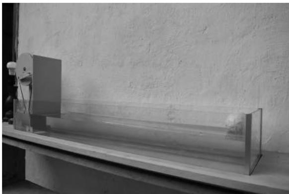
Figura 2. Prototipo, generador de ondas.
