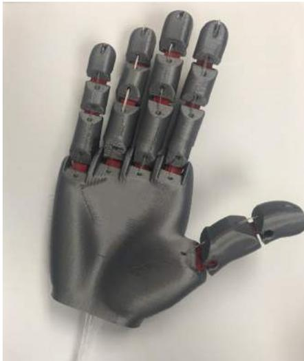
**Figura 7.** Mano ensamblada. Fuente: Los Autores
