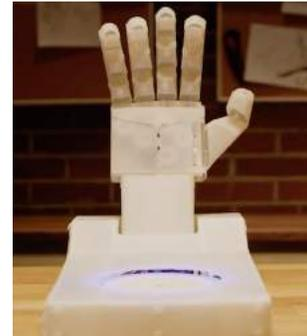
**Figura 3.** Modelo 1: Mano articulada de nylon y acrílico. Fuente: Deeplocal.
