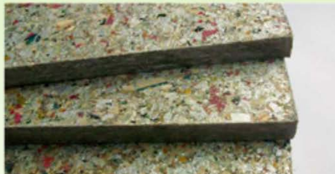
Fig. 5. Láminas de poli aglomerado de plástico y aluminio. (Representaciones Industriales Orion, 2009)
