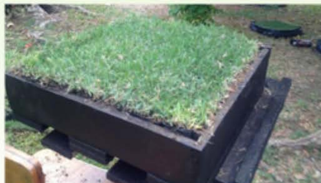
Fig. 14. Vista final prototipo de módulo de techo verde. Fuente: Autor.
