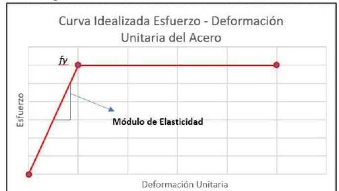
**Figura 4.** Curva Idealizada Esfuerzo – Deformación Unitaria del Acero. Fuente: Diseño de Estructuras de Acero, McCormac (2013), pág. 133 [3].
