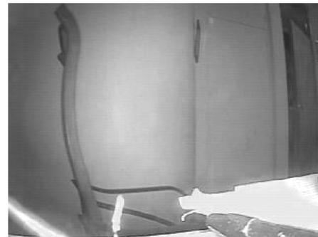
**Figura 14.** Imagen de prueba con distorsión radial negativa.
