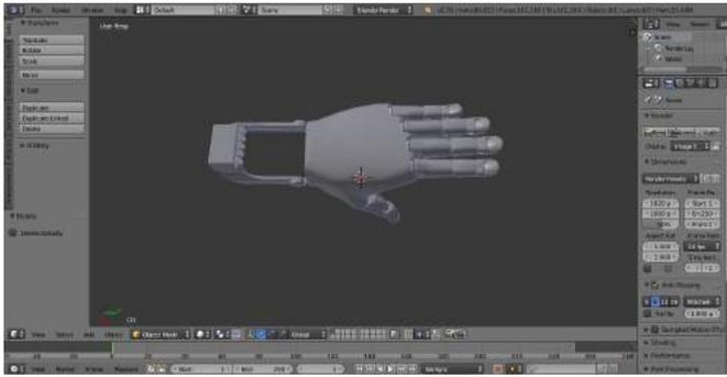
Figura 1. Diseño en Blender del Prototipo 1.
