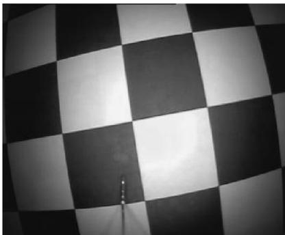
**Figura 11.** Imagen de prueba con distorsión radial negativa.
