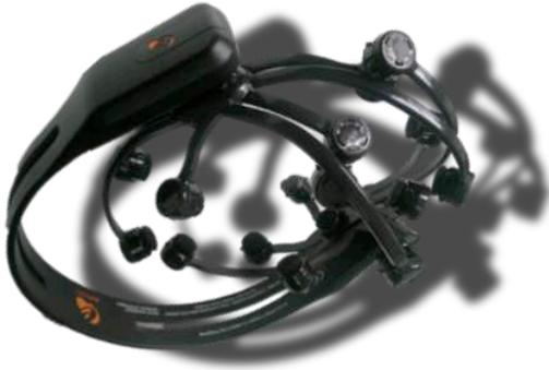
**Figura 1.** Interfaz de captura de señales encefalográficas Emotiv EPOC.
