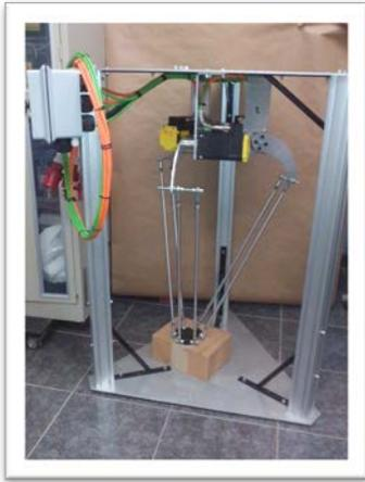
**Figura 5.** Robot Paralelo tipo Delta.
