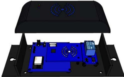
**Figura 1. Prototipo Lector RFID WiFi.**
