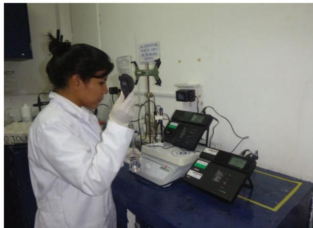
proporcional a la concentración de nitrógeno amoniacal, y ésta a su vez al cambio de potencial que se registra en el potenciómetro.
