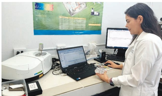
Figura 1. Ensayo de Identificación de plásticos utilizando la Espectroscopia Infrarroja con Transformada de Fourier (FTIR) y la Reflectancia Total Atenuada (ATR)
