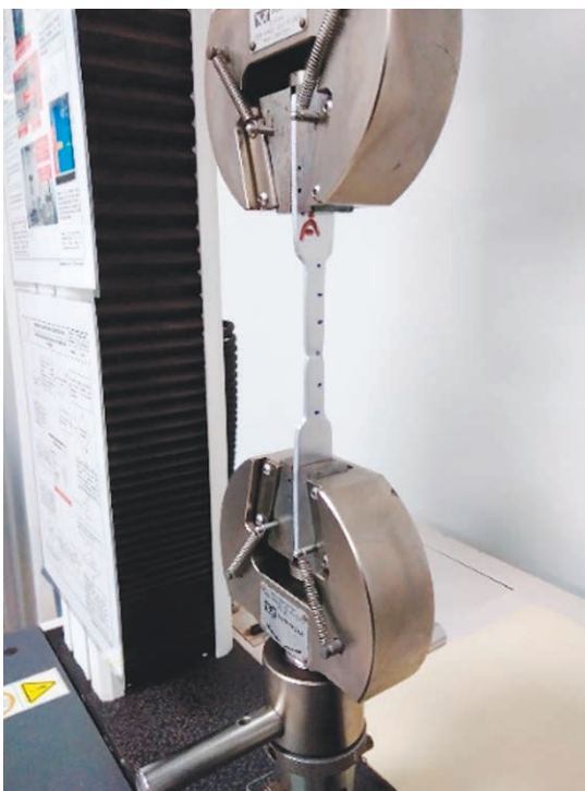
Figura 2. Ensayo de tensión de una probeta normalizada, extraída del material base de los cilindros de aluminio.
