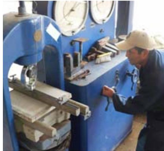
Dentro de las propiedades que evaluamos en LEM a los materiales cerámicos tenemos: dimensionamiento, absorción de agua, determinación de la carga de rotura, determinación de la resistencia a la compresión, determinación de la resistencia al impacto, determinación de la resistencia a la abrasión, entre otras.
