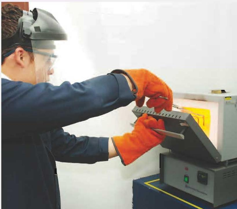
*Extracción de muestra de horno de alta temperatura (mufla).*
