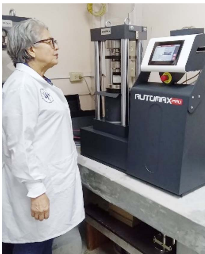
Figura 1. Ensayo físico realizado al cemento por norma ASTM C109.
