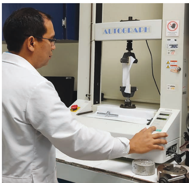
Figura 1. Ensayo de resistencia a la rotura por tensión y corte de probetas según las direcciones de los hilos.
