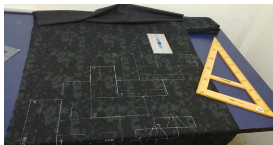
Figura 2. Corte de espécimen para ensayo.
