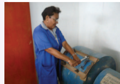
Desgaste los Ángeles La Figura 3 , indica la prueba de Los Ángeles, que nos permite determinar la resistencia al desgaste por rozamiento de los agregados.
