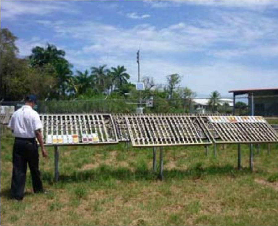
Exposición de probetas de acero bajo condiciones de exterior.
