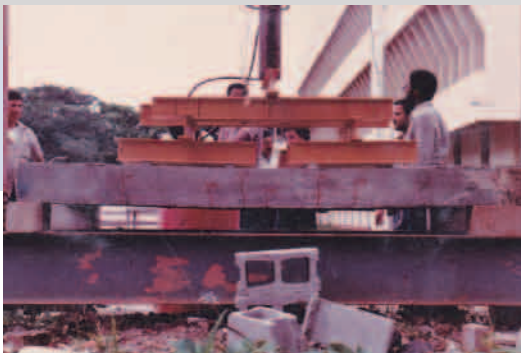
Estudiantes de hormigón II probando una losa para verificar la capacidad calculada.
