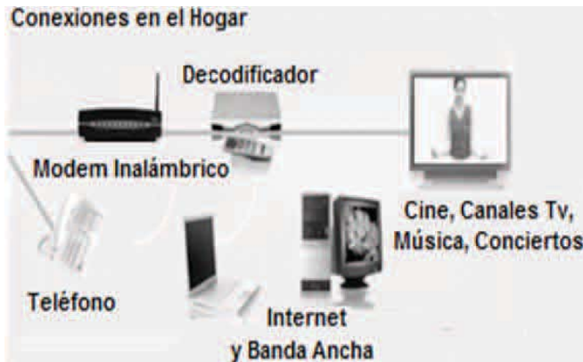
Figura 1. Equipo requerido en servicio triple-play de IPTV[1].
