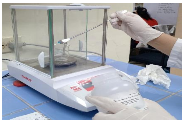
Figura 4. Uso de la balanza para pesar el sulfato de cobre pentahidratado.
