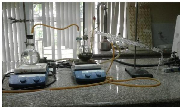
Figura 1. Equipo de destilación por arrastre de vapor.
