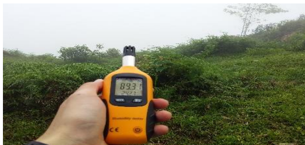
Figura 11. Medición de la Humedad Relativa.
