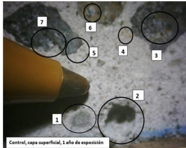
Figura 4. Hallazgos de daños, muestra control, un año de exposición ambiental.
