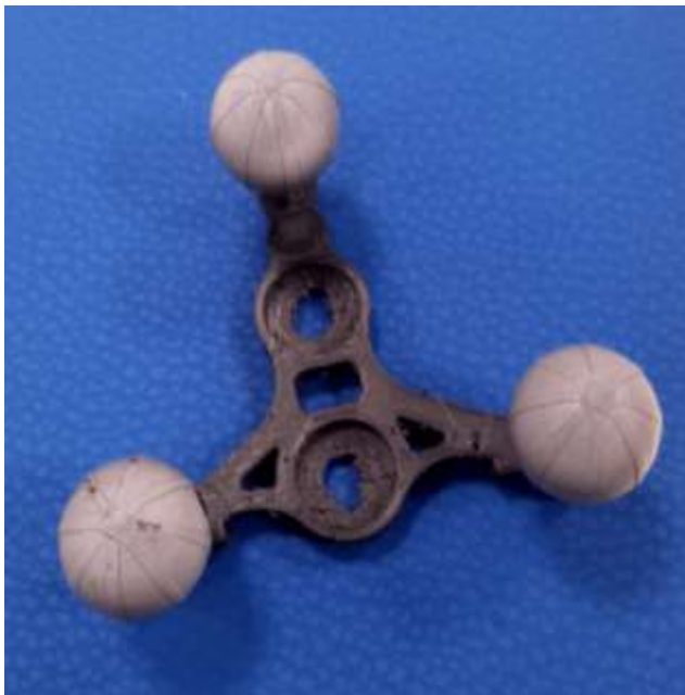
Figura 3. Soporte impreso con marcadores colocados en cada una de sus secciones.
