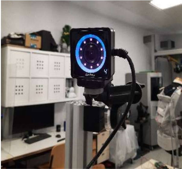
Figura 2. Cámara OptiTrack PrimeX13W dirigida a la zona de captura del movimiento.
