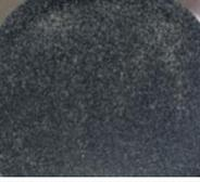
(f) | Tamiz # 200.<br>Abertura del Tamiz: 0.075 mm.<br>Retenido: 106 g.<br>Descripción: Para el tamiz #200 se presenta claramente minerales de magnetita en 95% y 5% de cuarzo.                                         |
