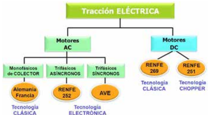
Figura 3. Clasificación de locomotoras con tracción eléctrica.
