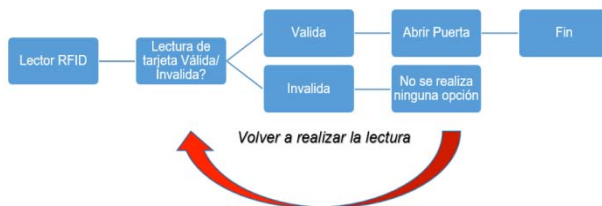
Figura 3. Esquema conceptual de entrada por medio de lector RFID.
