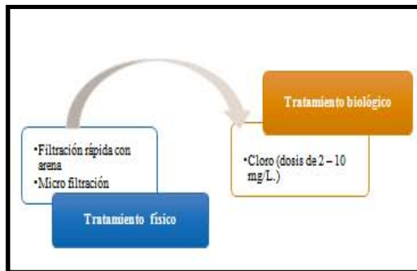
Figura 7. Tratamiento de potabilización de las fuentes de aguas superficiales.
